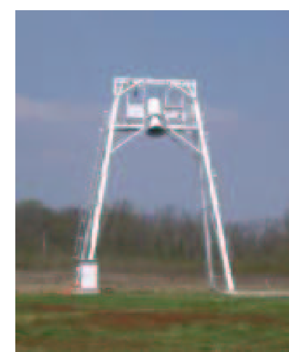
FIG.5 Radiomètre LEWIS fixé à 13.7 m de hauteur. Ici en position de routine à 40° d'incidence sur la jachère.
