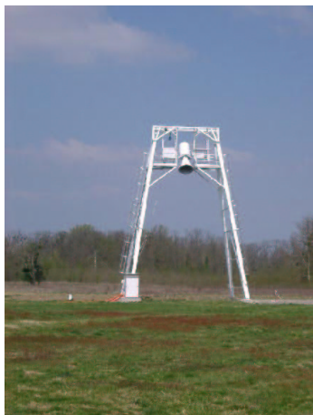
FIG. 5 – Radiomètre LEWIS sur son portique à 13.7 m de hauteur. Sur cette photo LEWIS est en position de routine, pointant à 40^\circ d'incidence sur la jachère.
