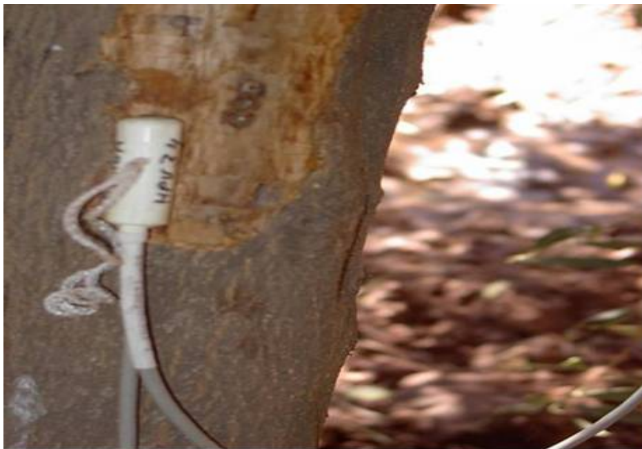
Figure 2. 11. La mesure du flux de sève par la méthode HRM (Heat Ratio Method).
