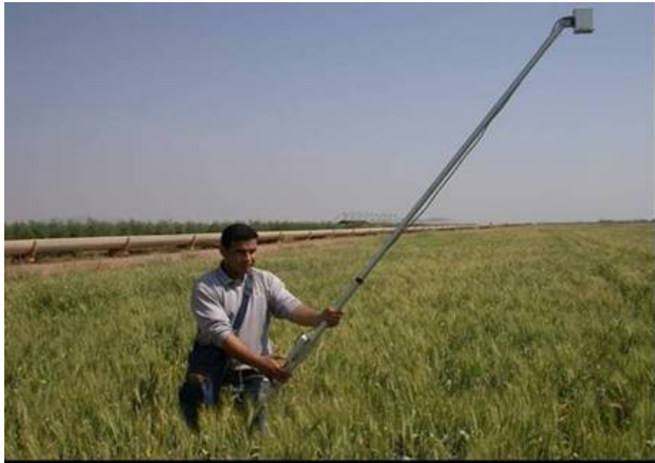
Figure 2. 10. La mesure des reflectances du blé à l'aide d'un radiomètre portable multi spectral (Crop Scan, MSR87).
